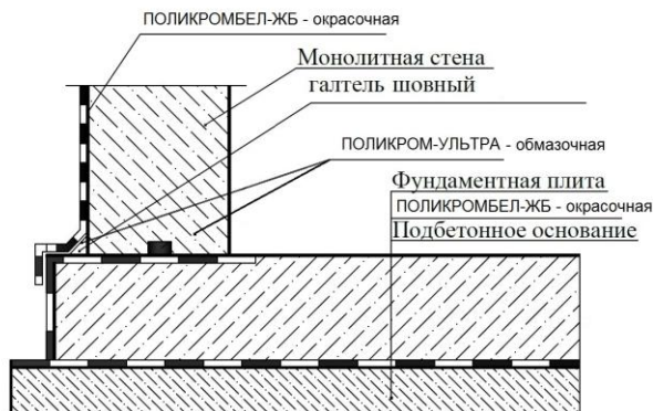
Гидроизоляция плитного фундамента
