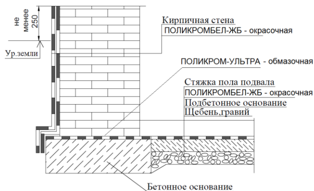
Гидроизоляция кирпичного фундамента
