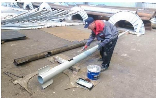
Рисунок 3.5 - Антикоррозионная защита конструкций дорожно-транспортной инфраструктуры
